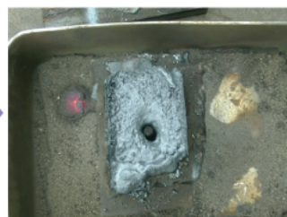
④貫通後の被穿孔物
